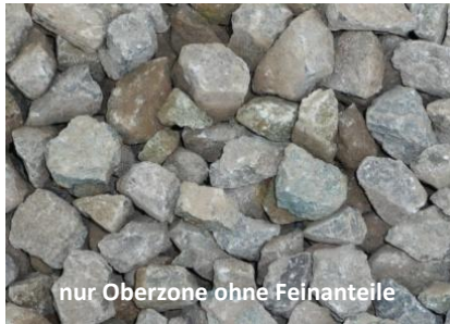
verdichtete Schottertragschicht (mit hohlraumreicher Oberzone)
